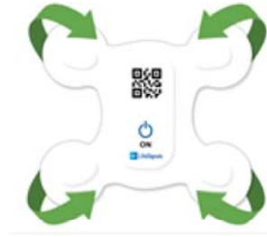
الشكل 5 - إزالة الغطاء الواقي المغلف من المستشعر الحيوي
